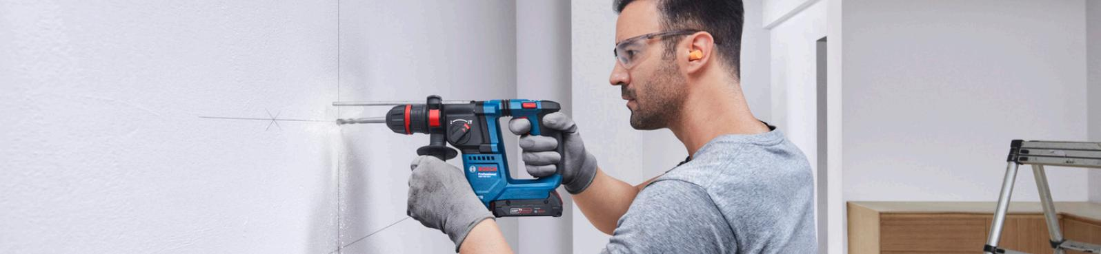
Par ailleurs, l'éclairage LED et la fonction Vario-Lock, qui permet de faire pivoter et verrouiller le burin dans différentes positions, offrent un confort de travail optimal, même dans les endroits exigus et sombres.
